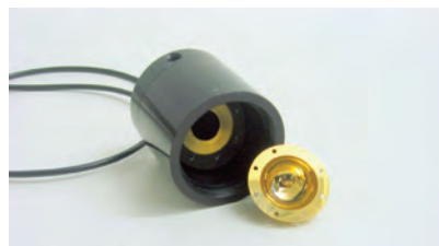
Obr. 10: Pyroelektrický detektor s demontovanou reflexní hemisférou
